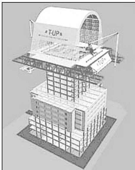
Rys. 5. Schemat zautomatyzowanego systemu wznoszenia budynku T-UP [13]
